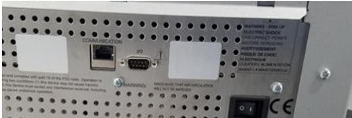
Figura 2-41: Porta AUX I/O dello spettrometro di massa
