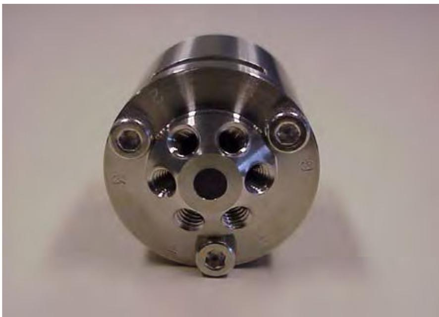
5. Installare la valvola di iniezione con le porte 6 e 1 rivolte verso l'alto.
