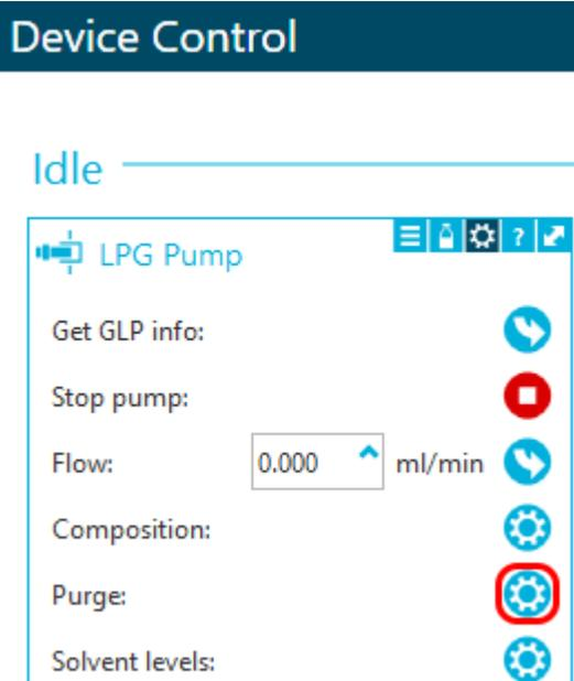
5. Selezionare il canale da spurgare, quindi avviare la pompa a una velocità di flusso di 4 mL/min.
