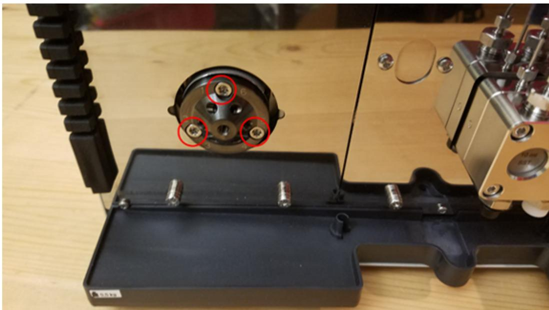
3. Retire el estator del cuerpo de la válvula.
