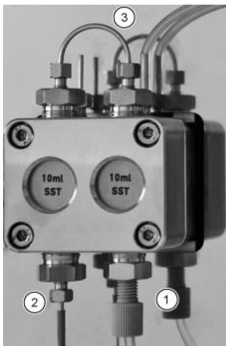
1. Mientras sujeta el cabezal de la bomba con una mano, apriete alternativamente los cuatro tornillos de estrella.
