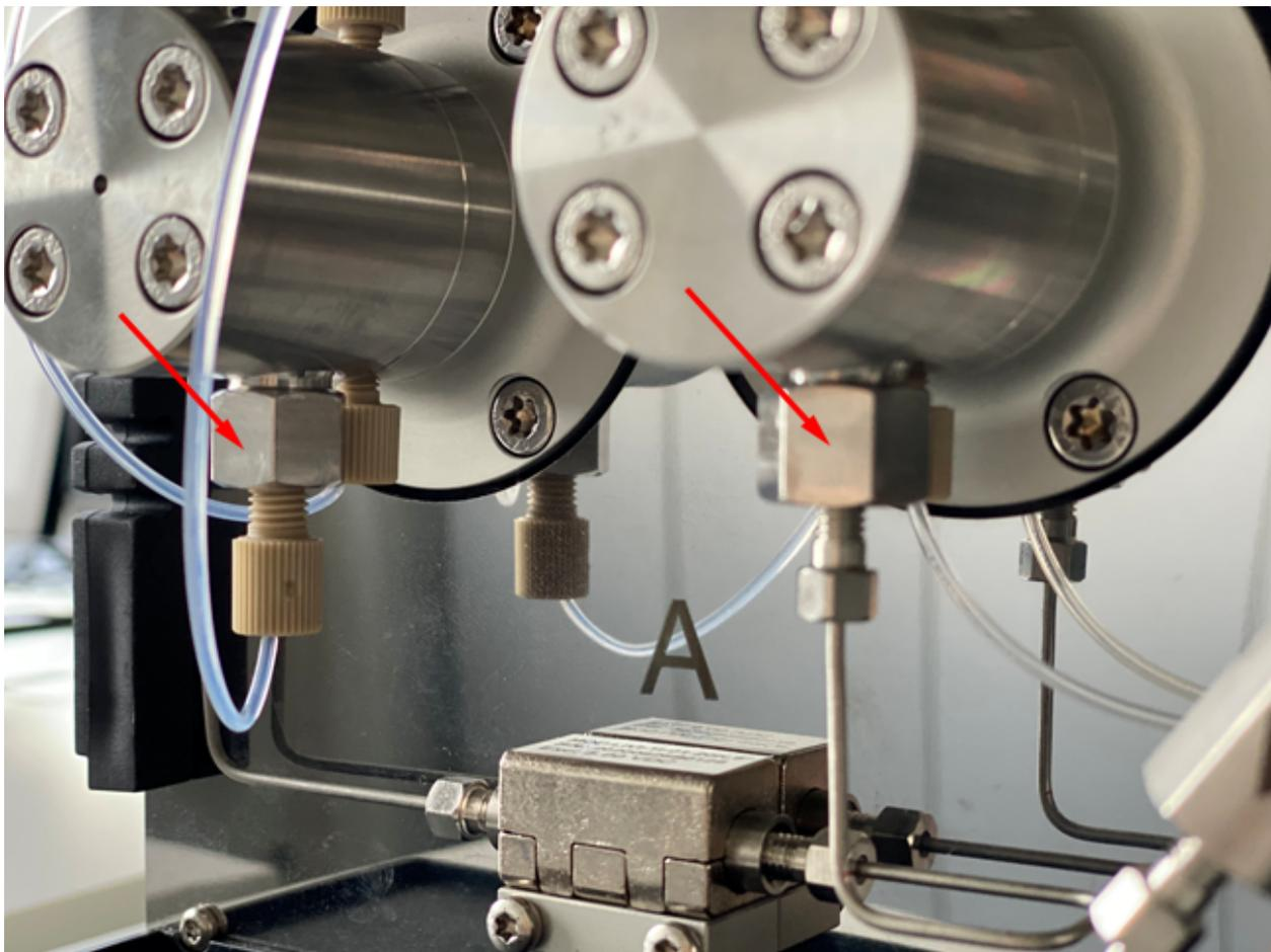
1. Desconecte el tubo de fase móvil del soporte de la válvula de retención.
