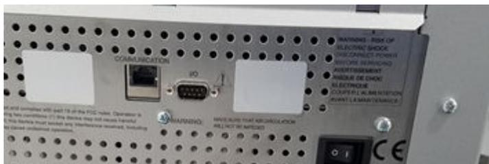
**Figura 2-41: Puerto AUX I/O del espectrómetro de masas**
