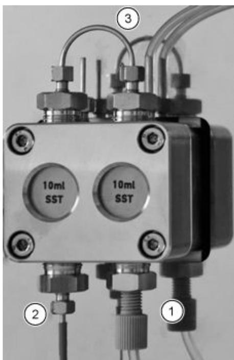
2. Afloje el conector de 0,25 pulgadas (elemento 2) de la salida de la bomba y luego desconecte el capilar.
