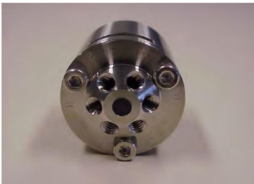
5. Instale la válvula de inyección con los puertos 6 y 1 hacia arriba.
