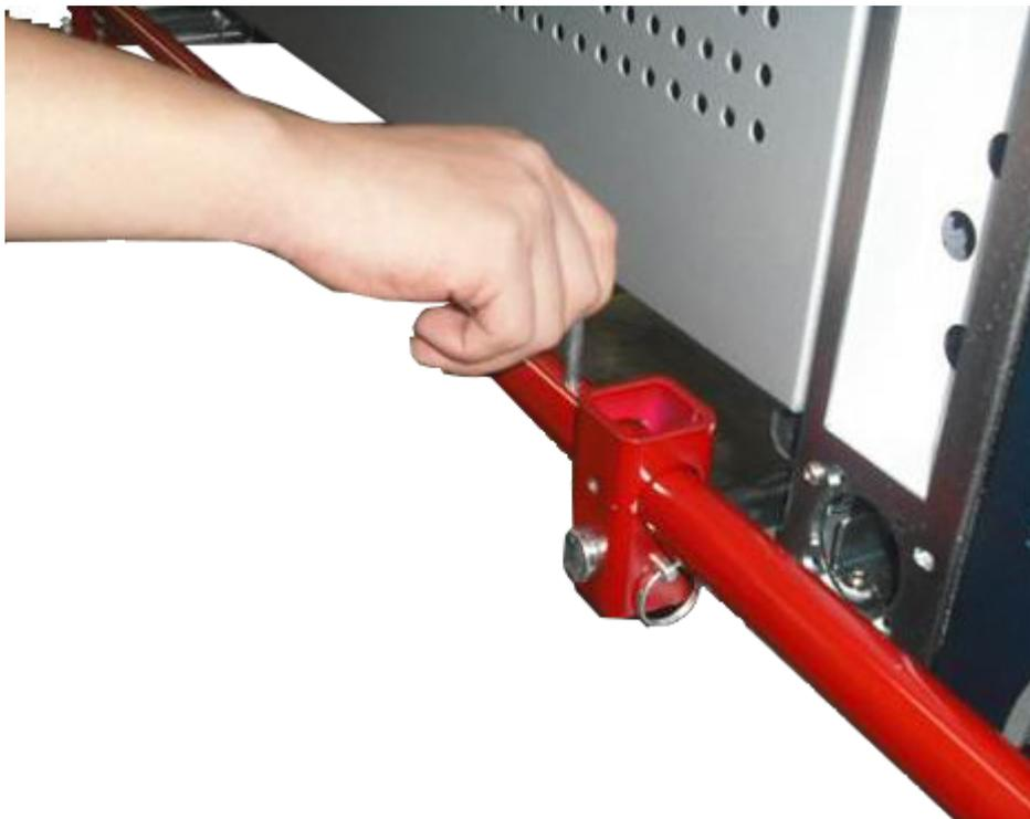
11. 在质谱仪后部，在长棒两端安装高挡块，然后用两个锁定销固定挡块。
