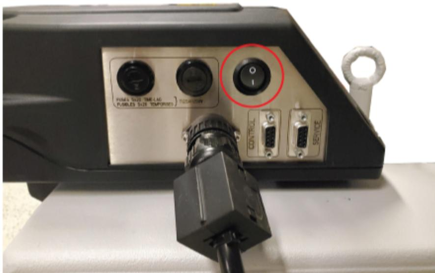
干式泵：确保泵背面的断路器已接通，然后按下前面板上的启动按钮。
