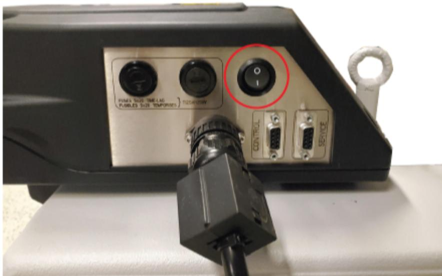
Bomba seca: asegúrese de que el disyuntor de la parte trasera de la bomba está encendido y, a continuación, pulse el botón Start del panel frontal.
