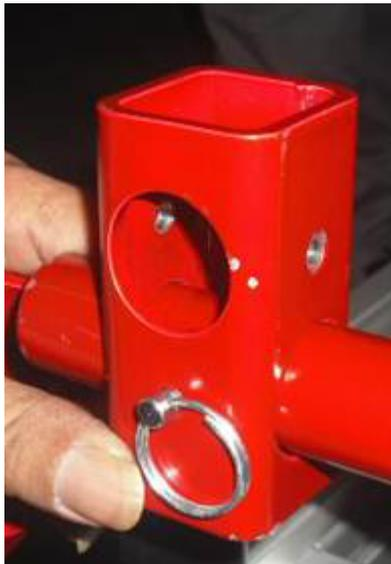
12. En la parte posterior del espectrómetro de masas, inserte una varilla corta a través de los bloques altos.
