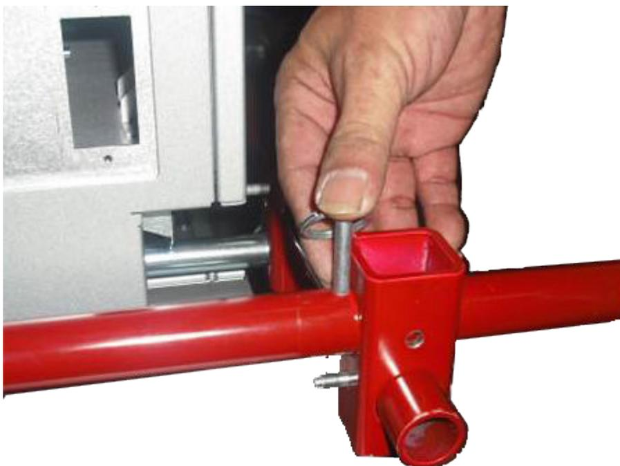
Figura 5-13: Kit de izado instalado
