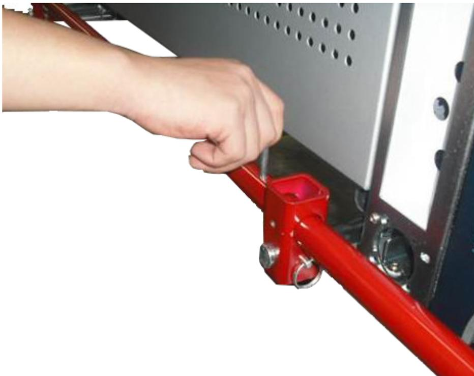
11. Instale los bloques altos en los extremos de las varillas largas en la parte posterior del espectrómetro de masas y luego fije los bloques con dos pasadores de bloqueo.
