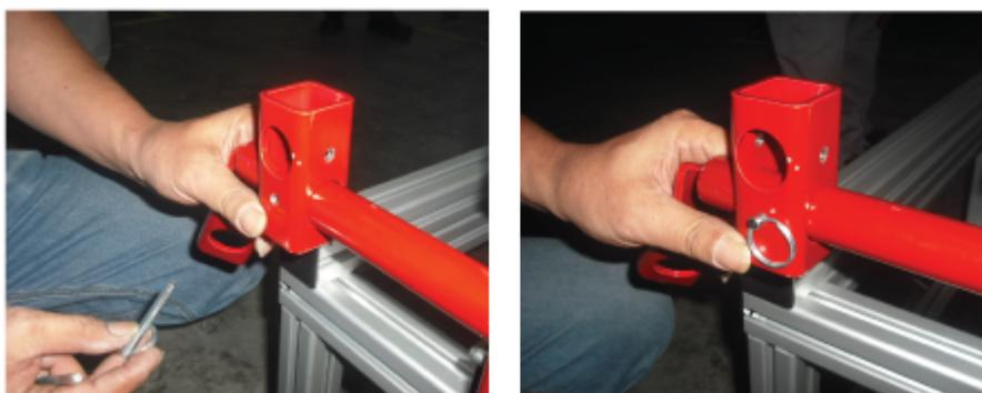
8. En el lado derecho del espectrómetro de masas, inserte una varilla larga que atraviese los bloques.
