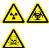
**WARNHINWEIS! Gefährdung durch ionisierende Strahlung, Biogefährdung oder toxisch-chemische Gefahren. Verwenden Sie die Ionenquelle nur, wenn Sie Kenntnisse über die ordnungsgemäße Verwendung, Eingrenzung und Entsorgung von mit der Ionenquelle verwendeten toxischen oder schädlichen Materialien haben und darin geschult wurden.**
