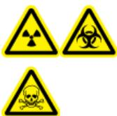
**AVVERTENZA!** Pericolo di contaminazione da radiazioni ionizzanti, rischio biologico o pericolo di esposizione ad agenti chimici tossici. Assicurarsi che la ventilazione dei gas di scarico avvenga mediante una cappa aspirante apposita da laboratorio o attraverso un sistema di scarico; assicurarsi inoltre che il tubo di ventilazione sia fissato con morsetti. Verificare che il laboratorio abbia un ricambio di aria appropriato per il lavoro eseguito.
