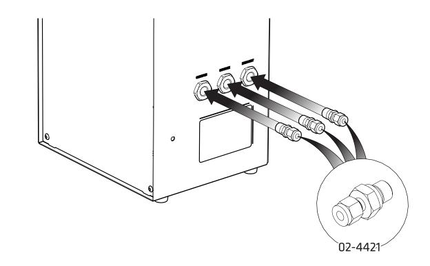
Befestigen Sie die **drei1/4"-Klemmverschraubungen 02-4421** an den Auslässen von Gasvorhang, Zufuhr
