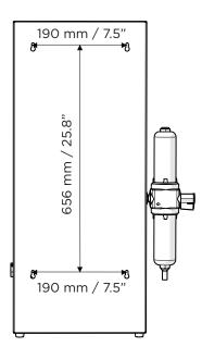
Der Generator kann an der Wand montiert werden. Wenn Sie Ihren Generator nicht an der Wand montieren möchten, fahren Sie mit Schritt 4 fort.
