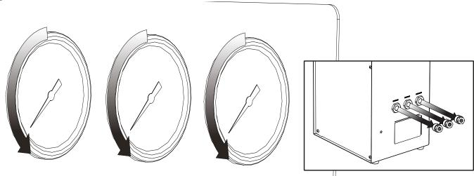
Der Spülvorgang ist nun abgeschlossen. Trennen Sie die Luftzufuhr ab. Sobald die Manometer an der Generator-Vorderseite den Wert null (0) anzeigen, **können Sie die Schalldämpfer-Verbinder** von den Anschlüssen von Gasvorhang, Zufuhr- und Abluft entfernen.
