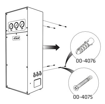
Sobald sich die Bohrungen an den gewünschten Stellen befinden, fügen Sie die vier **Wanddübel Nr. 8, 00-4076**, und die vier **Schrauben Nr. 8, 00-4075**, in die Wand ein und montieren Sie Ihren Generator daran.
