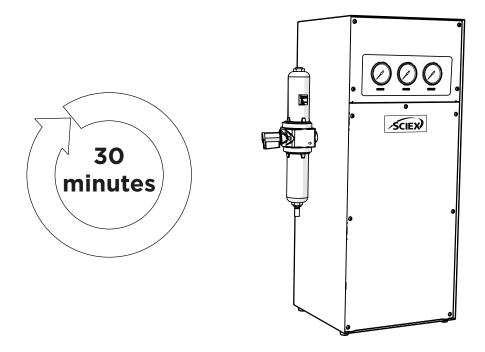
Lassen Sie den Generator **30 Minuten** lang an **Ihre Luftzufuhr angeschlossen**, um das System zu spülen.
