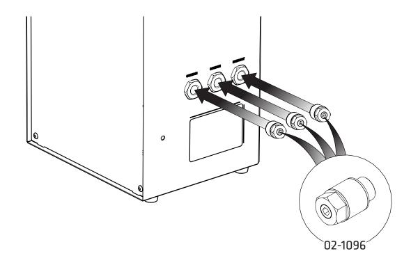
Befestigen Sie die **drei Strömungsschalldämpfer O2-1096** an den Auslässen von **Gasvorhang (curtain), Zufuhr** und **Abluft** an der rechten Generatorseite.
