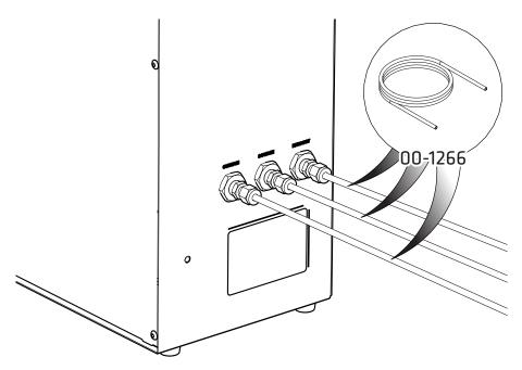
Verbinden Sie den mitgelieferten 1/4"-PTFE-Schlauch 00-1266 mit den drei 1/4" x 1/4"-Klemmverschraubungen 02-4421.
