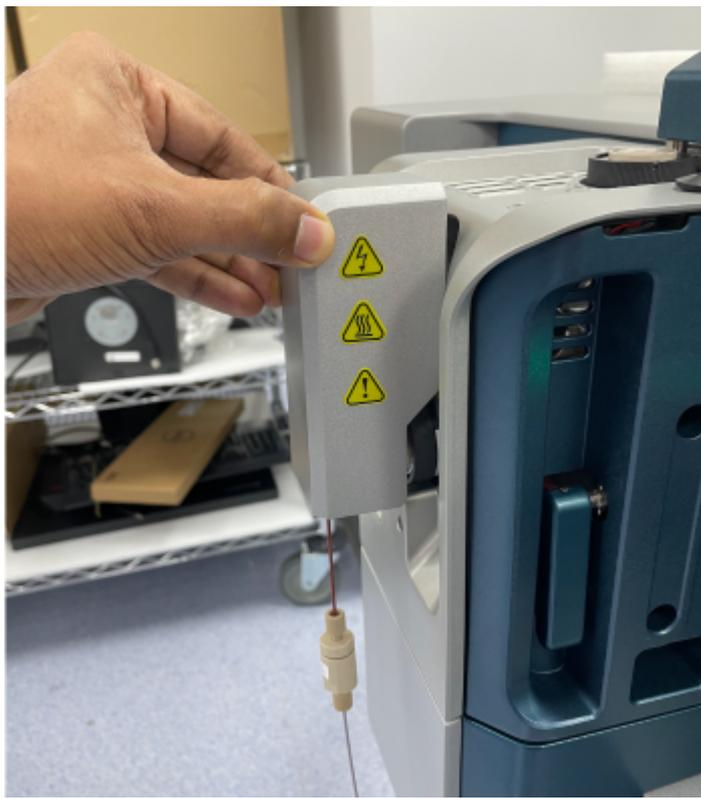
5. Para garantir que o sistema possa funcionar, coloque o poste de montagem do adaptador no orifício de posição da fonte de íons.
