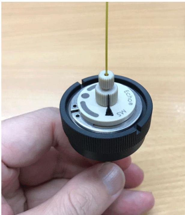
11. Instale uma sonda na fonte de íons.
