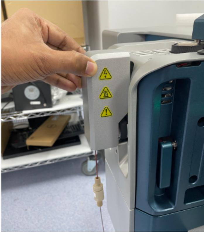
5. Para asegurarse de que el sistema pueda funcionar, introduzca el poste de montaje del adaptador en el orificio de colocación de la fuente de iones.
