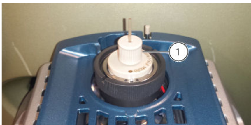
図 3-5 : 下部フィッティングの取り付け
