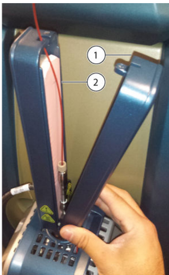
Illustration 3-12 : Chauffage de la colonne
