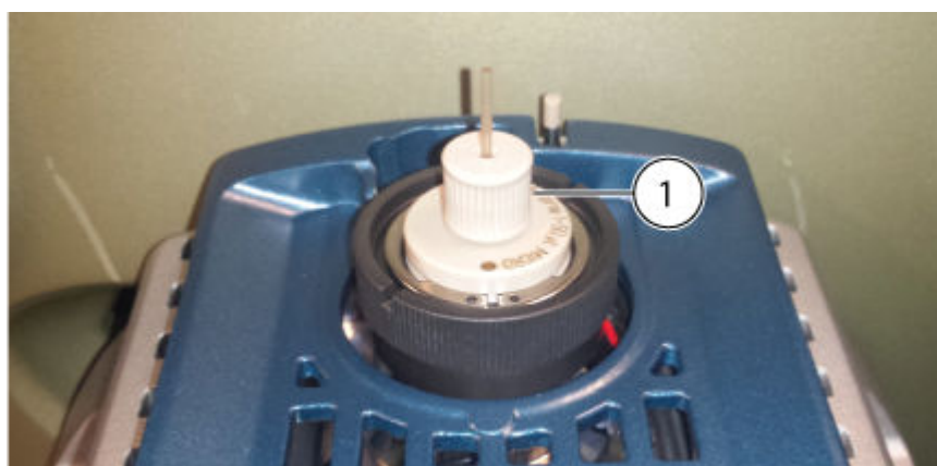
Illustration 3-5 : Raccord inférieur installé
