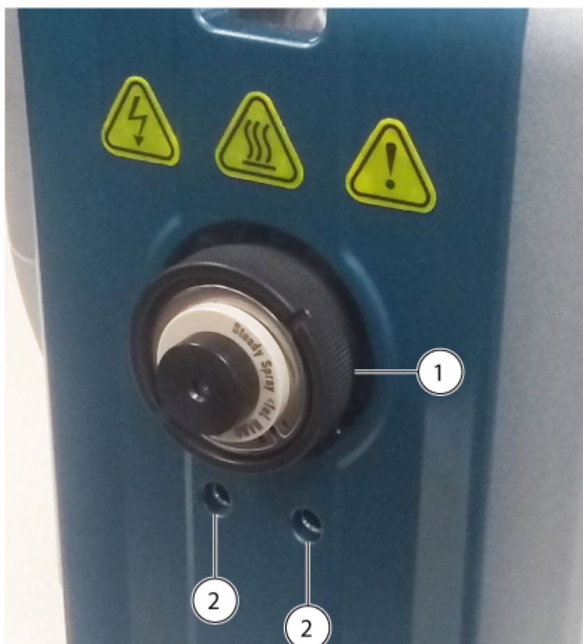
Figura 3-20: Conexión del calentador de columna Nano en la fuente de iones
