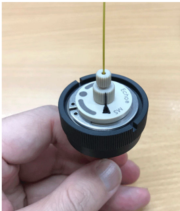
Figura A-8: Marcas del conjunto de electrodos y de la sonda alineadas
