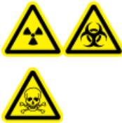
**AVERTISSEMENT !** Risque de rayonnement ionisant, risque biologique ou risque de toxicité chimique. Déterminer si une décontamination est nécessaire avant de procéder au nettoyage ou à l'entretien. Si des matériaux radioactifs, des agents biologiques ou des substances chimiques toxiques ont été utilisés avec le système, le client doit décontaminer de ce dernier avant d'en effectuer le nettoyage ou la maintenance.
