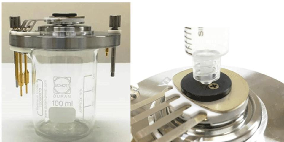
6. Remplir la seringue de 5 ml avec 5 ml de solution de nettoyage.
