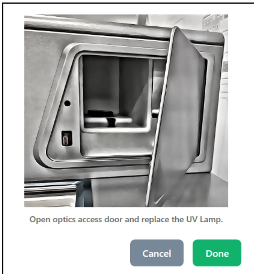
2. Drücken Sie auf dem Instrument die untere linke Ecke, um die Zugriffsklappe für Optikbehälter zu entsperren und öffnen. Eine Sicherheitssperre schaltet den Strom zur Lampe aus, wenn die Zugriffsklappe geöffnet ist.
