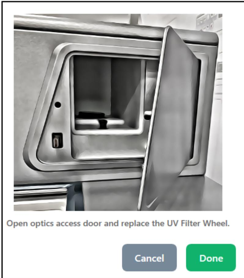
2. Drücken Sie auf dem System die untere linke Ecke, um die Zugriffsklappe für den Optikbehälter zu entsperren und zu öffnen.
