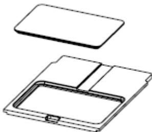
4. Verwenden Sie ein feuchtes Tuch oder ein Labortuch, um die Unterseite des Probendeckels und die Plattenbehälterabdeckung zu reinigen.
